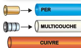
Si vous utilisez des tubes PER ou MULTICOUCHE vous devez mettre en place l'insert adapté avant la connexion.
